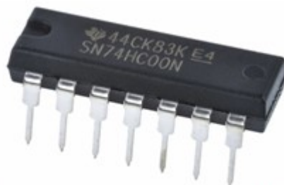
Circuito integrado com 4 portas NAND
